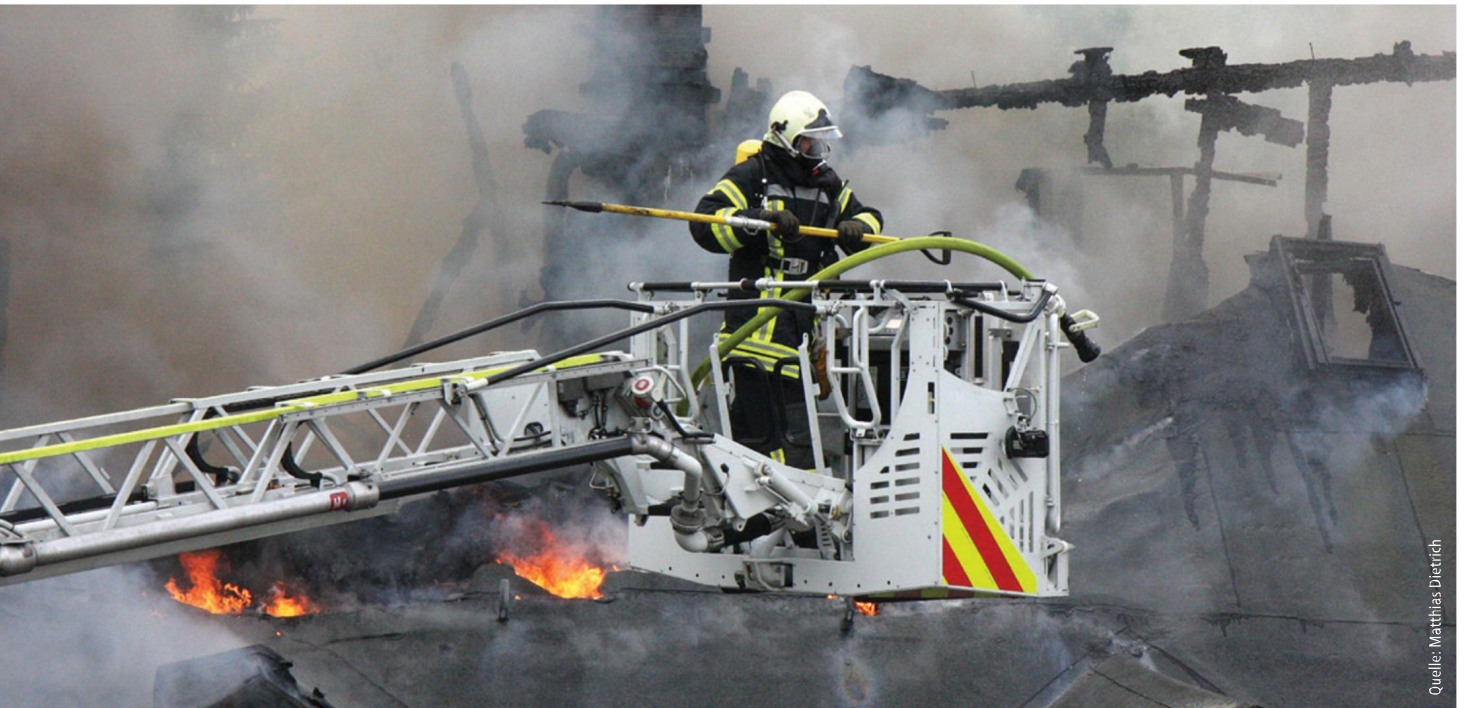
Abb. 1: Normgerechte Hubrettungsfahrzeuge verfügen über ein großes Benutzungsfeld.
