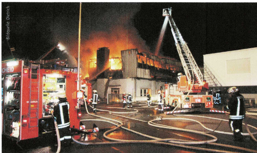
Abb. 6: Meist genügt es, wenn ein Hydrant mit einer Löschwasserleistung von mind. 400 l/min in einer Entfernung von 100 m über verlegte Schlauchleitungen zur Verfügung steht. Die Verlegung dieser Leitungslänge lässt sich in der Regel mit der Beladung eines normgerechten Löschfahrzeuges problemlos realisieren.
