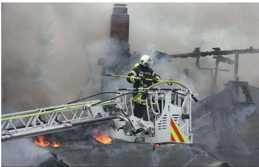
Die Rettungskörbe der modernen Drehleitern haben sich bezüglich der Abmessungen und der möglichen Lastaufnahmen gegenüber älteren Modellen erheblich vergrößert.
